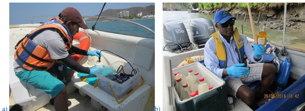
Figura 1-2. Salida de campo REDCAM. Medición de parámetros in situ (a), foto: Programa CAM; recolección de muestras de agua (b), fotos: CVC.
