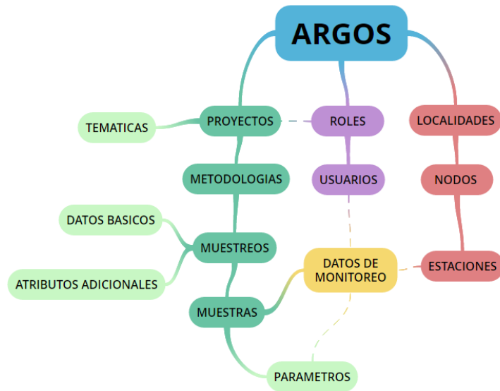
Figura 15-11. Diagrama de la estructura de la base de datos de la REDCAM en ARGOS.
